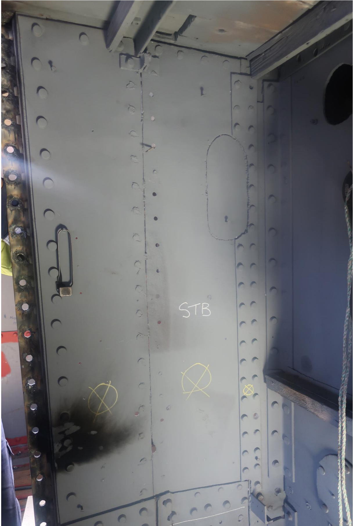
Akre skott på styrbord side i dekkshuset for billett-/postkontoret på Jøsenfjord. Foto BDF 2020.
