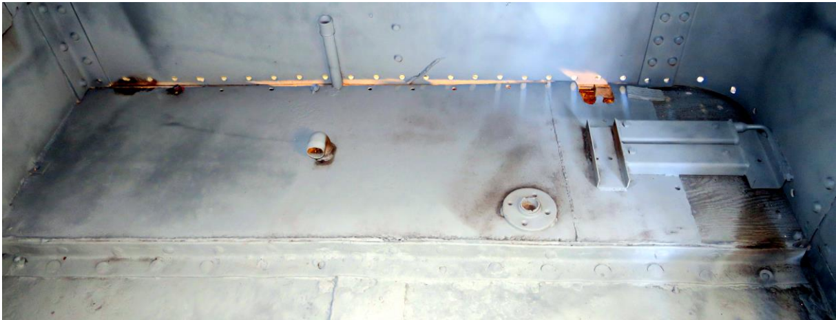
Det opphøyde, aktre trinnet i dekket var av stål, bortsett fra lengst mot styrbord, hvor det var tredekk.
