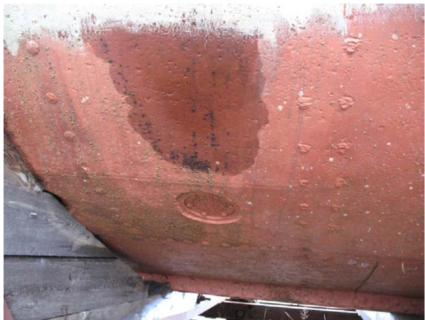
Eksempel på diesel lekkasje
